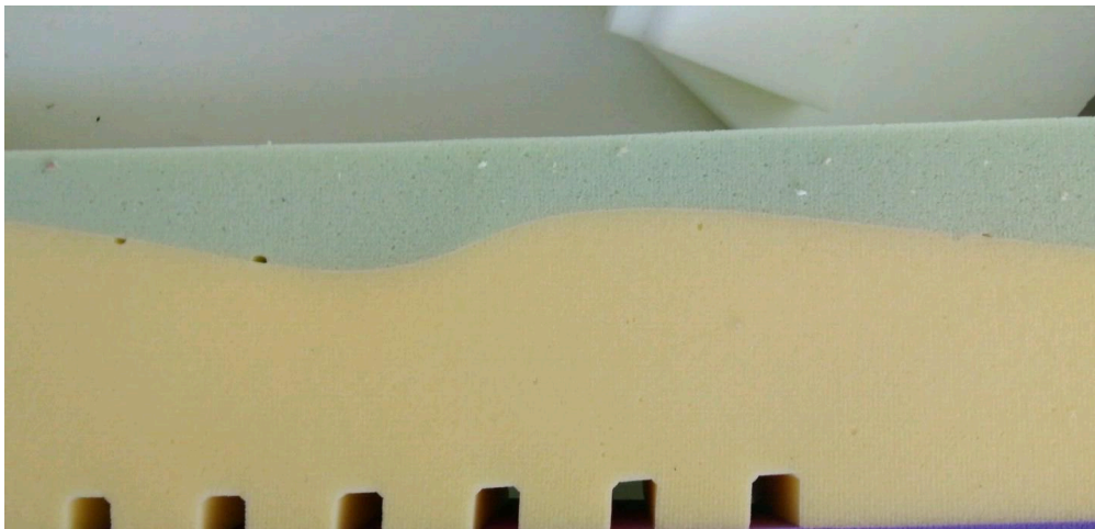
Figura 12. Núcleo del colchón en el que se aprecian las dos capas de espumación unidas
