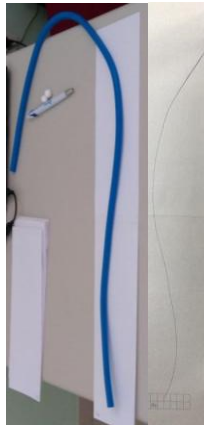
Figura 4. Regla flexible para registrar manualmente la forma externa de la columna vertebral y ejemplo de curva
