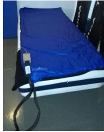
Figura 2. Sábana con sensores de presión utilizada en el proyecto
